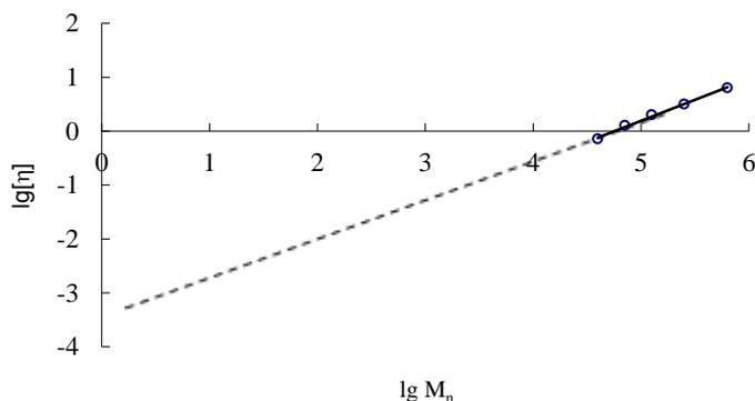
Из построенного графика зависимости  $\lg[\eta] = f(\lg M_n)$  находим:
